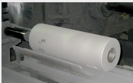
Bild 1: Mit graphithaltiger Suspension vorbehandelter Zirkoniumbolzen (Quelle: IAS GmbH)
